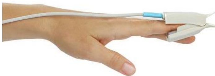
Рисунок 4.26 - Наложение пульсоксиметрического датчика прищепочного типа
